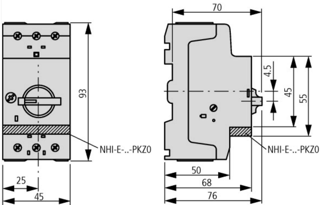
Disjoncteur de protection moteur avec contacts auxiliaires de position
