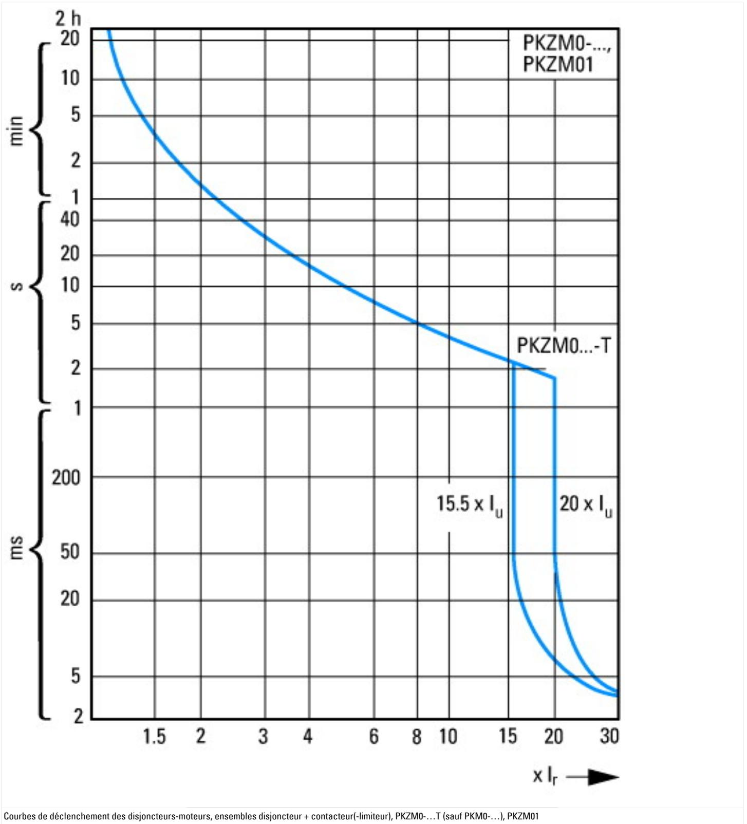
Courbes de déclenchement des disjoncteurs-moteurs, ensembles disjoncteur + contacteur(-limiteur), PKZM0...T (sauf PKM0...), PKZM01
