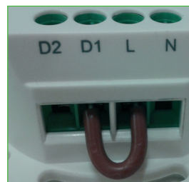
Bornas para la conexión del cableado
